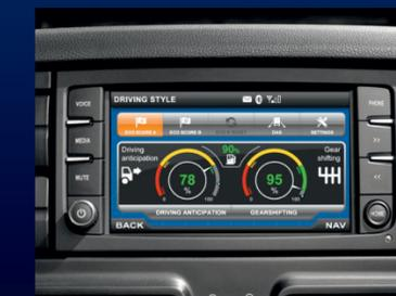
La pantalla táctil IVECONNECT integrada, incluye la tecnología DSE (evaluación del estilo de conducción) y DAS (sistema de alerta en la conducción) para asistir y ofrecer mayor seguridad al conductor.
